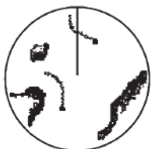
(a) Traînes des cibles en mode Réel (absence de bavure pour les cibles stationnaires)
