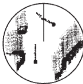
(b) Traînes des cibles en mode Relatif (déplacements relatifs des cibles par rapport au bateau)
