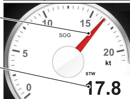
Ecrã SOG (Velocidade em terra firme)
