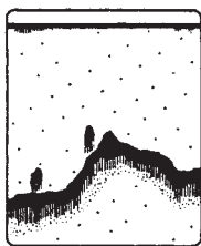
Störsignale eines anderen Echolotes
