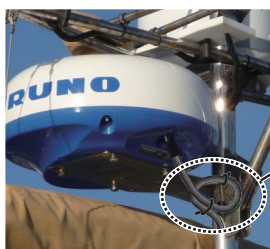
Φτιάξτε έναν βρόχο με το καλώδιο και δέστε τον με σφιγκτήρες καλωδίων.
