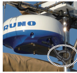
Kabelschleife und -binder Schleife mit Kabelbindern.
